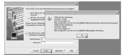
Eine solche Meldung deutet darauf hin, dass die Zugangsdaten und/oder der Name des Rechners, auf dem die SSDE installiert ist, falsch angegeben wurden. Bestätigen Sie die Meldung mit einem Klick auf OK, überprüfen Sie Ihre Eingaben und wiederholen Sie den Vorgang.
